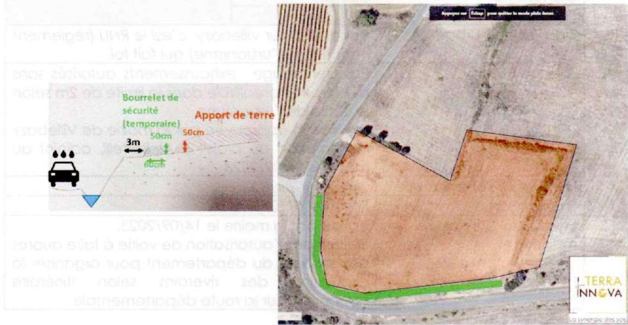
Figure 5 : Coupe de principe bourrelet de terre
