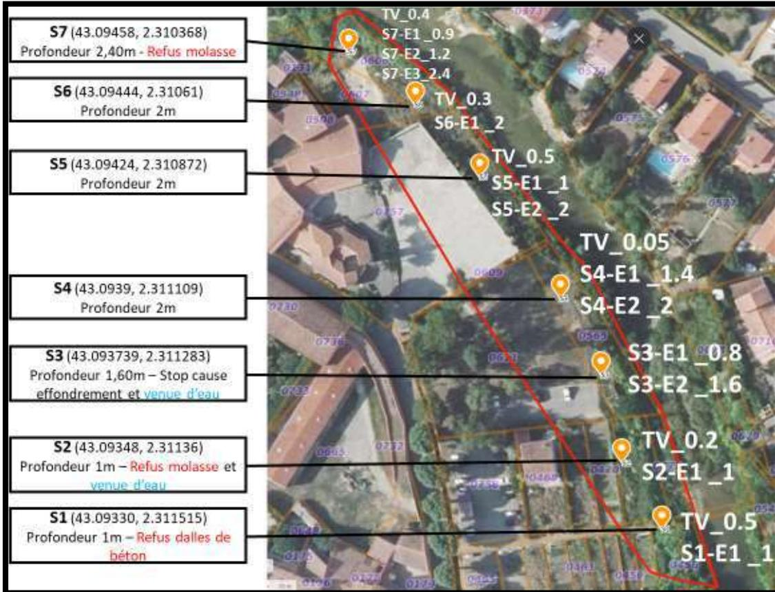
FIGURE 10 : SITE SUD - PROFONDEURS DE SONDRAGE EFFECTIVES ET ECHANTILLONS PRELEVES
