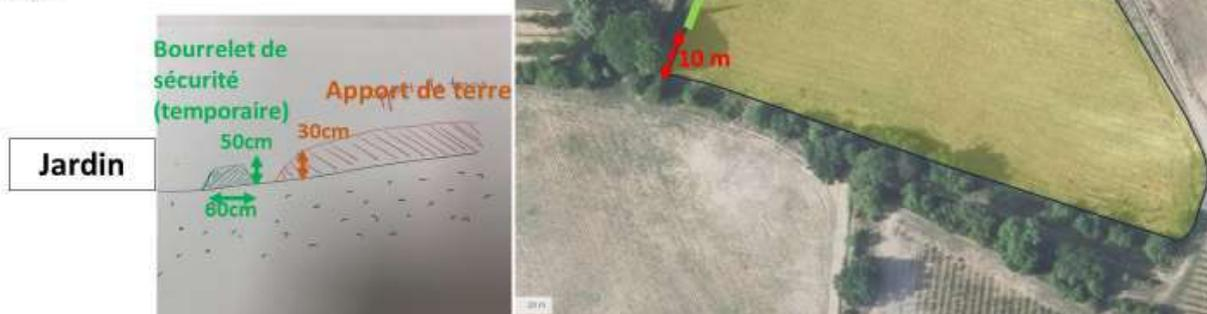
**FIGURE 74 : SCHEMA PRINCIPE BOURRELET DE TERRE PARCELLE G**
